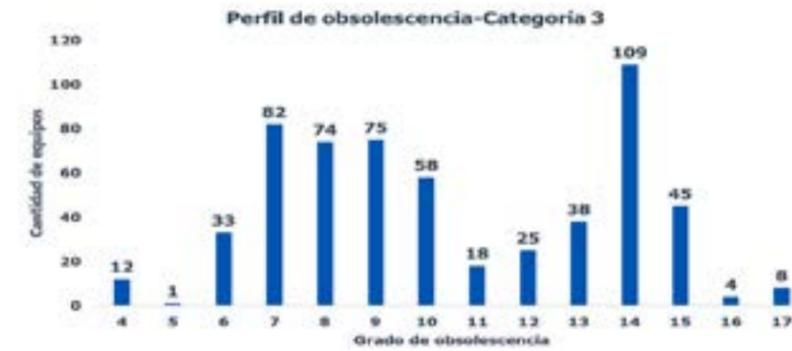
Figura 27. Perfil de obsolescencia en bahías y celdas de subestaciones.
